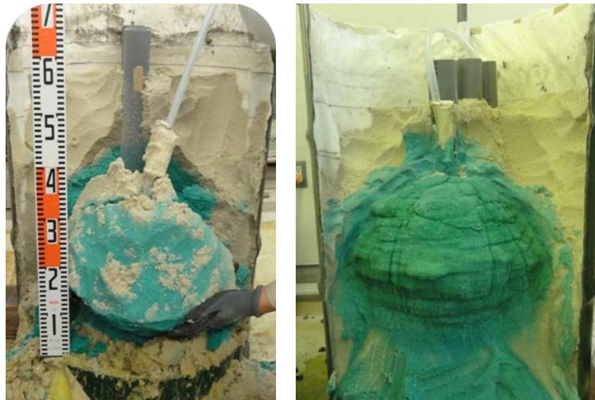
図-2 ドラム缶試験で得られた改良体の外観（一回注入（左），二回注入（右））
