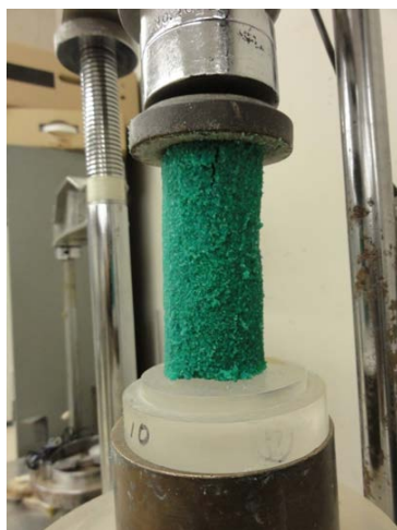
図-3 ドラム缶試験で得られた改良体の一軸圧縮試験結果
