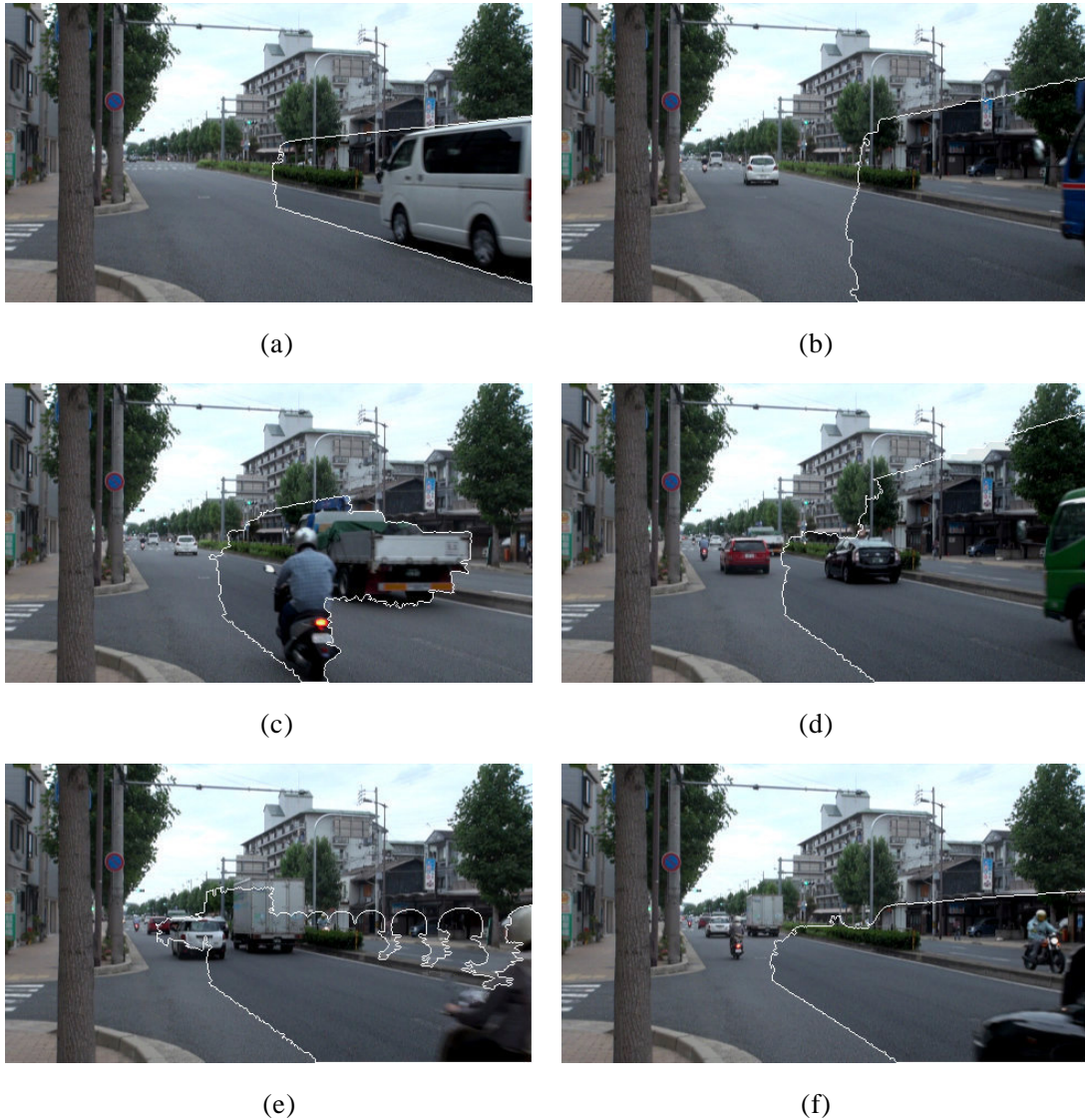
図2：地上撮影動画画像から抽出した車両軌跡。(a)図1(a)の四輪車の軌跡、(b) (c)図1(b)のトラック、二輪車の軌跡、(d)図1(c)のトラック、四輪車2台分を誤って抽出した軌跡、(e)図1(d)の二輪車の軌跡、(f)図1(e)の四輪車2台分を誤って抽出した軌跡
