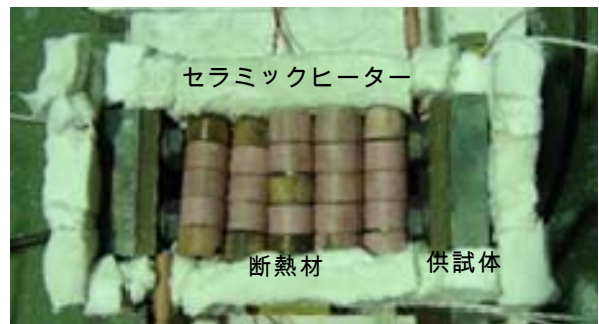
図-2 セラミックヒーターによる応力除去焼鈍
