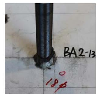
写真-1 付着破壊
