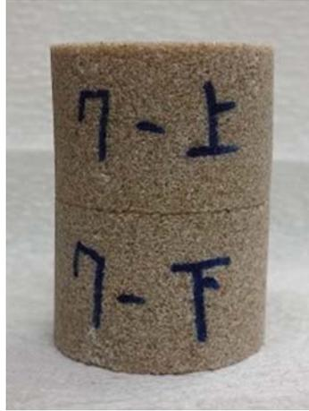
図3 岩石試験片（直径3cm）
