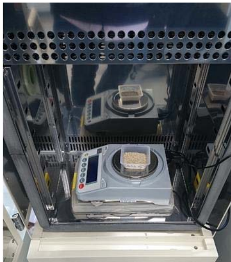
図6 恒温恒湿装置内に設置した電子天秤と焼結体粉末の様子
