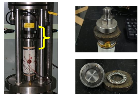
図2 三軸セル (左) と新しいキャップ (右)
