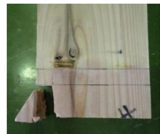
図4 鎌部分のせん断破壊 (⑧-1)
