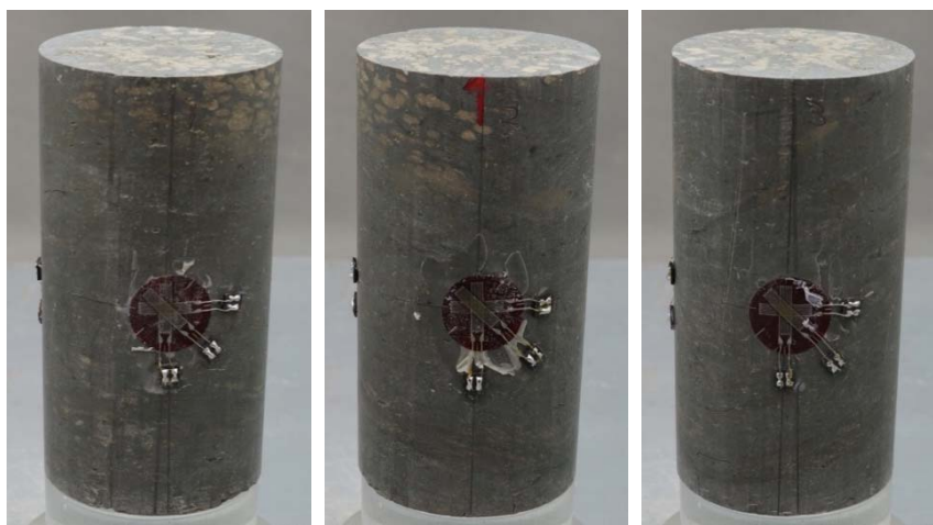
図4 載荷前の岩石供試体と3成分ひずみゲージの貼付状況（120度間隔で3方向から）
