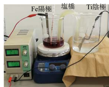
図-1 K 2 FeO 4 の電気化学的合成法のイメージ(上)と実験装置(下)
