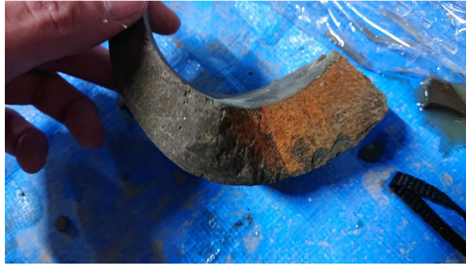
図 8 炭酸水注入後に採取された岩石サンプル
