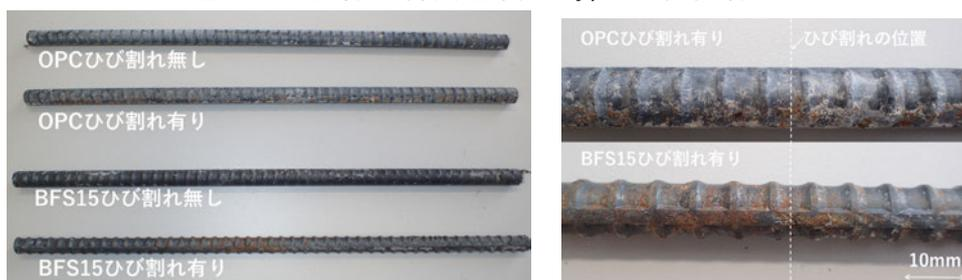
図-10 鉄筋の腐食状況 (Type A 供試体)
