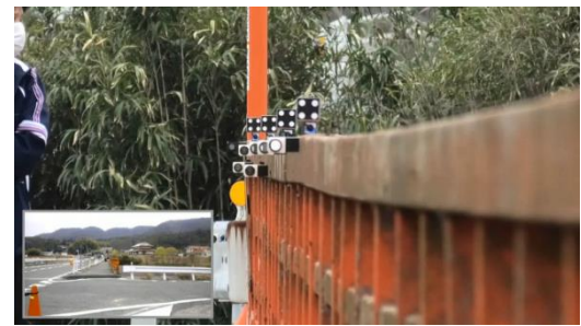
図 4-a タンデムマーカを使用した高フレームレート望遠カメラを用いた手法
