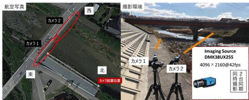
図 4-b カメラ設置位置の航空写真及び撮影環境
