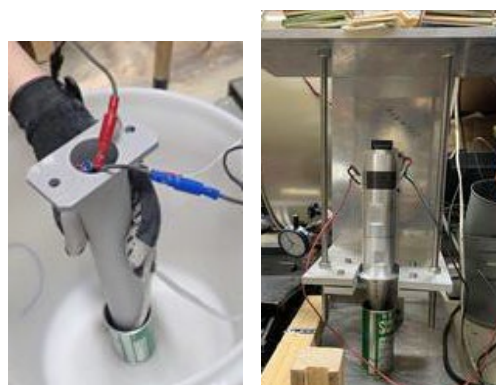
写真-3 超音波による締め固めの様子
