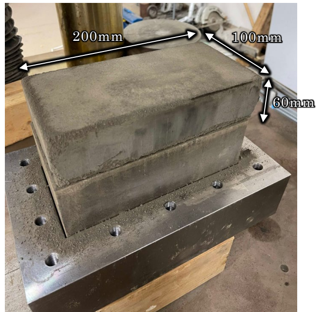
写真-7 振動と圧縮により固化したシミュラント
