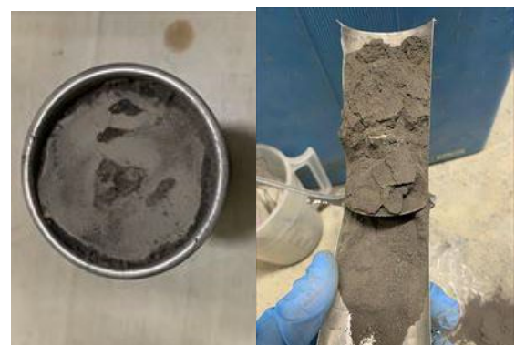
写真-4 脱型前のシミュラント(左), 脱型後のシミュラント(右)
