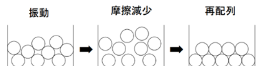
図-1 超音波による固化の仕組み
