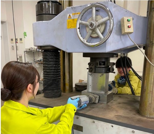
写真-5 型枠振動機と圧縮装置によるシミュラントの固化実験状況
