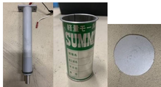
写真-1 超音波振動子(左), 円柱型枠(中), 金属板(右)
