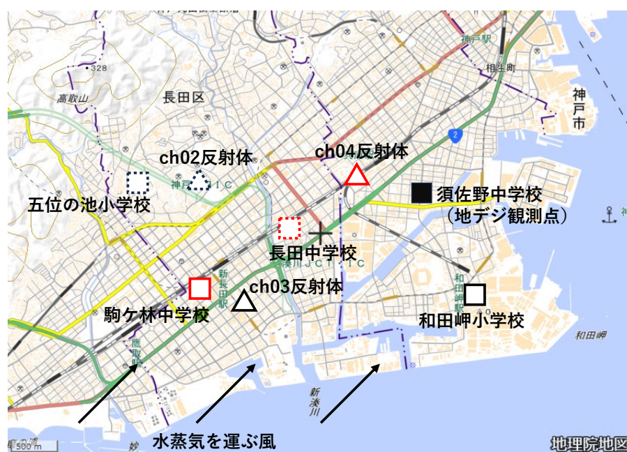
図 7：地デジ観測点・水蒸気量直接観測点の位置と反射体との位置関係。
