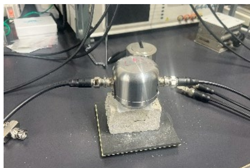
写真 1 誘電測定の状態
