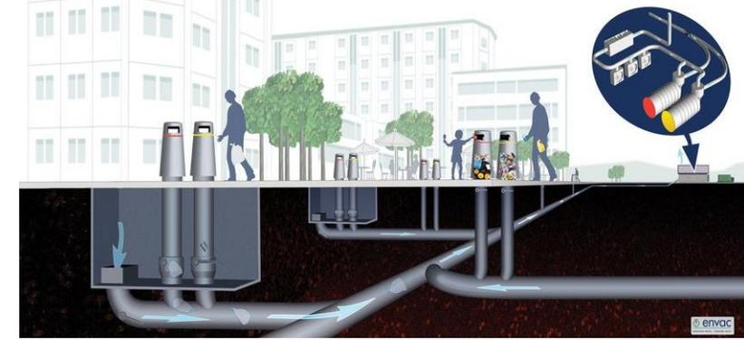
廃棄物自動収集システムのしくみ (https://www.inno4sd.net/portal-img/default/1/underground-waste-transportation-1-208.jpgより引用)
