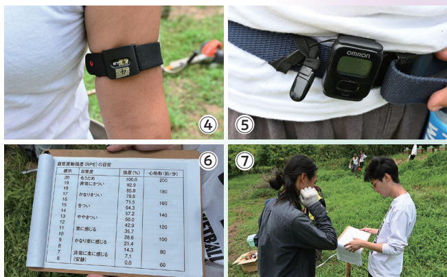
④腕に装着した心拍数測定器 ⑤腰には身体活動の強度をはかるMETs計測器 ⑥RPE (自覚的運動強度) の目安 ⑦休憩時に学生がRPEを聞き取り記録する
