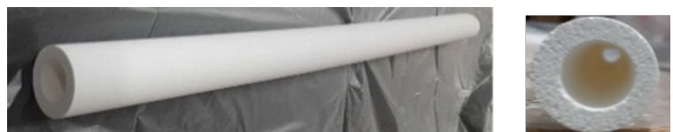
図-1 管状型リン吸着膜の外観（右：断面）
