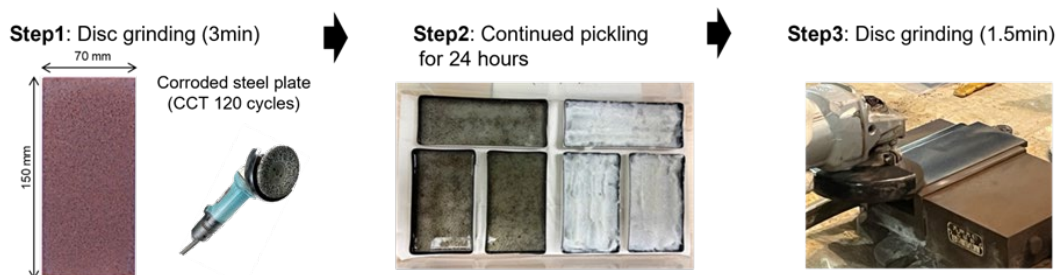
図 1 HA 工法の 3 ステップ処理手順図
