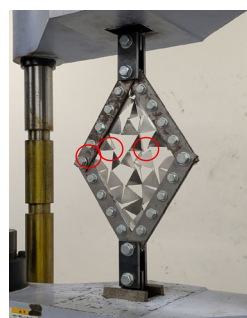
図 10 純せん断試験体(左:図面,右:破断時の様子)
