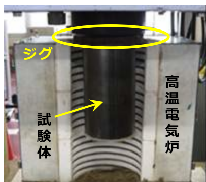
写真 2 電気炉設置状況
