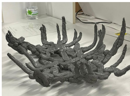
これらの試作は必ずしも定量的な構造性能評価を目的としたものではないが、3DCP と補強材を組み合わせることで、自由形状、軽量化、透過性、意匠性を備えた建築部材・建築プロダクトへ展開できる可能性を示すものである。
