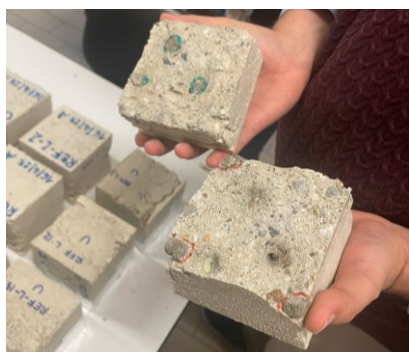
図 1：微生物カプセルを用いた コンクリート試験体
