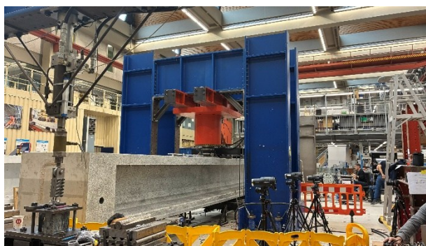
図 2：実物大 RC 梁の載荷試験の様子
