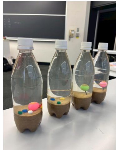
液状化再現装置(エッキー) 土木工学の知識を応用
